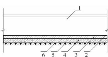
图 7.4.11-1 滤水层大样示意
