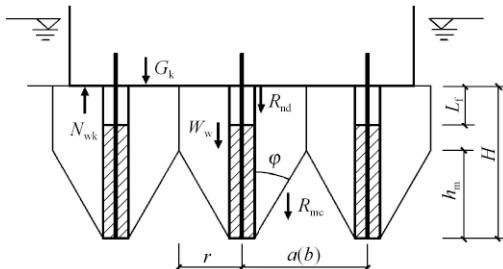
图 7.5.5 群锚效应锚杆抗拔承载模式示意
